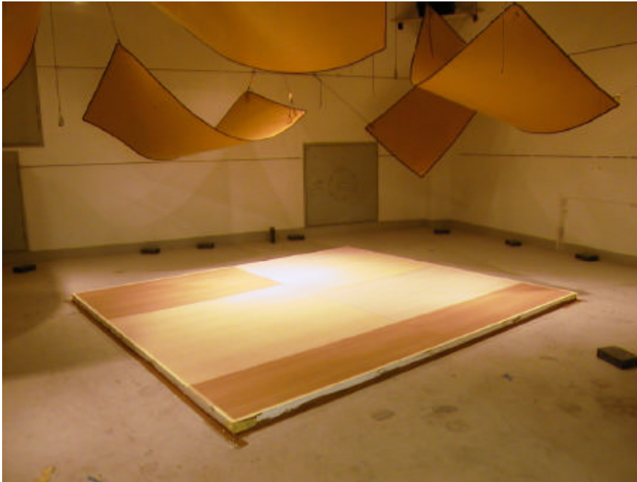
Abbildung 9: Prüfaufbau im Hallraum WILHELMI ® A 2 coustic, 50 mm Hohlraum, bedämpft
