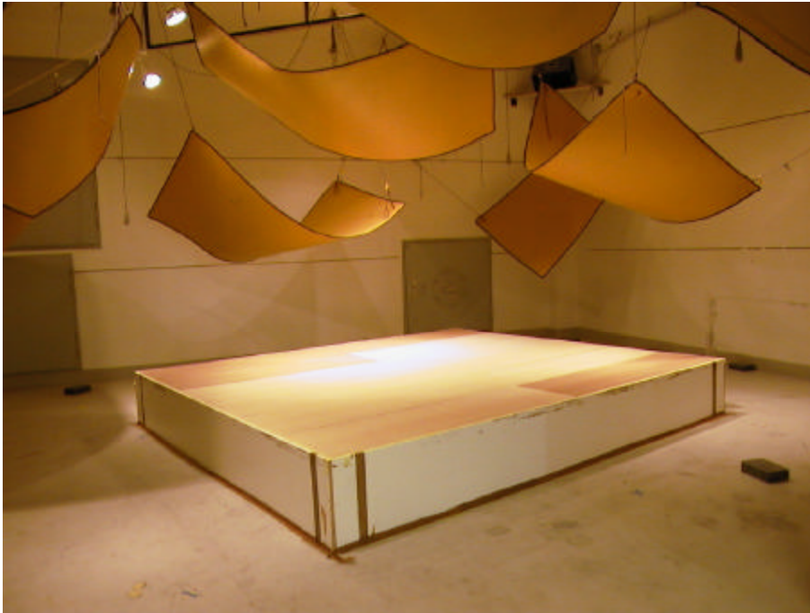
Abbildung 2: Prüfaufbau im Hallraum WILHELMI ® A 2 coustic, 400 mm Hohlraum, unbedämpft
