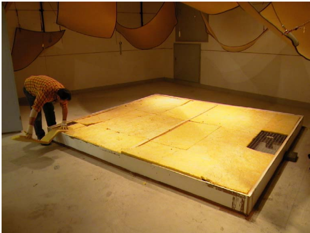
Abbildung 8. Ansicht offener Prüfaufbau während der Montage WILHELM I Alvaro® Glas, mit 200 mm Hohlraum, mit Bedämpfung aus 30 mm Faserdämmstoff, auf Tragrost verlegt
